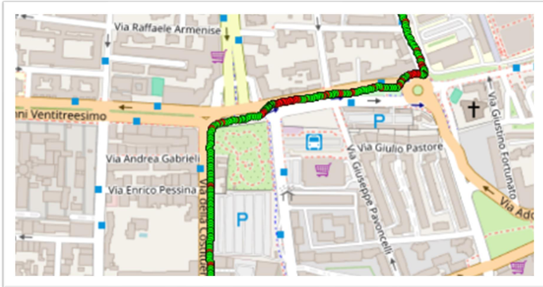
Mappatura e thresholding dei dati di accelerazione per indentificazione buche e altre irregolarità del manto stradale
